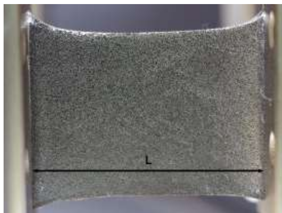
Fig. 4: Proba de PDMS fixată între bacurile mașinii de încercare la întindere
